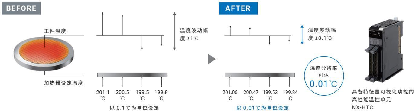
使用外部干扰抑制功能自动调整操作量，实现更为精细的控制
